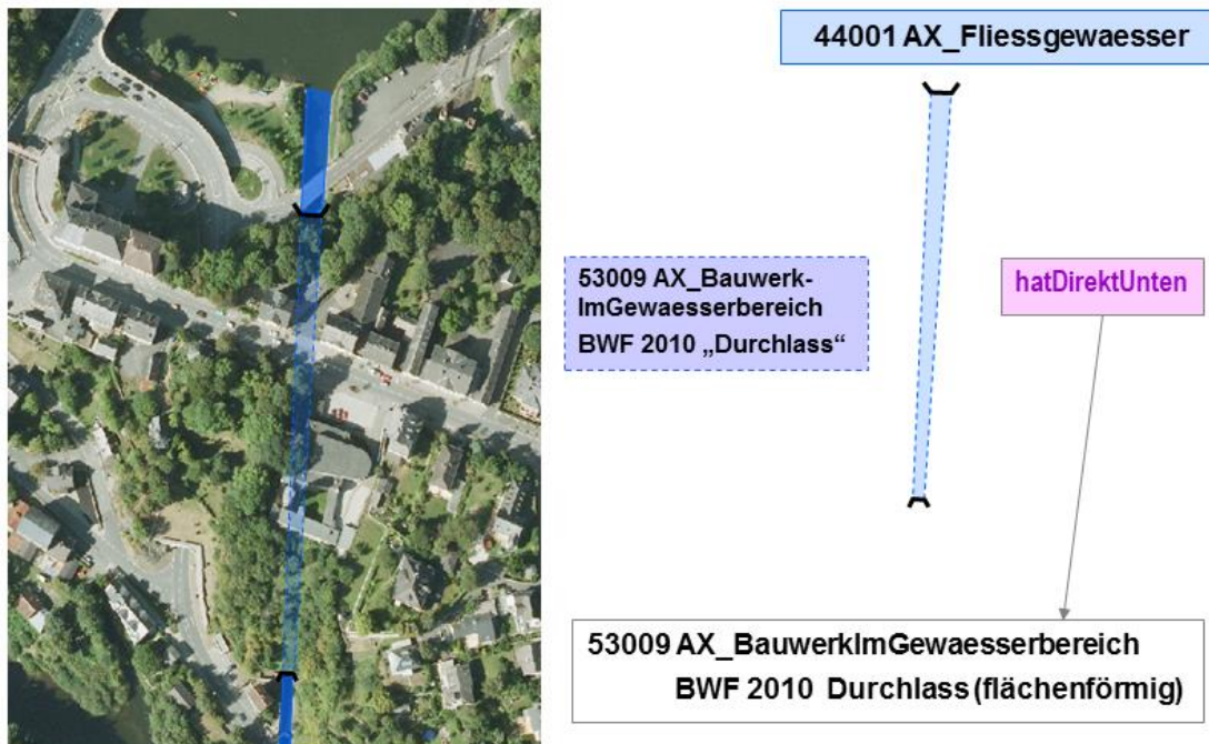
Abbildung 64: Modellierung eines flächenförmigen Durchlasses mit einem flächenförmigen Objekt
