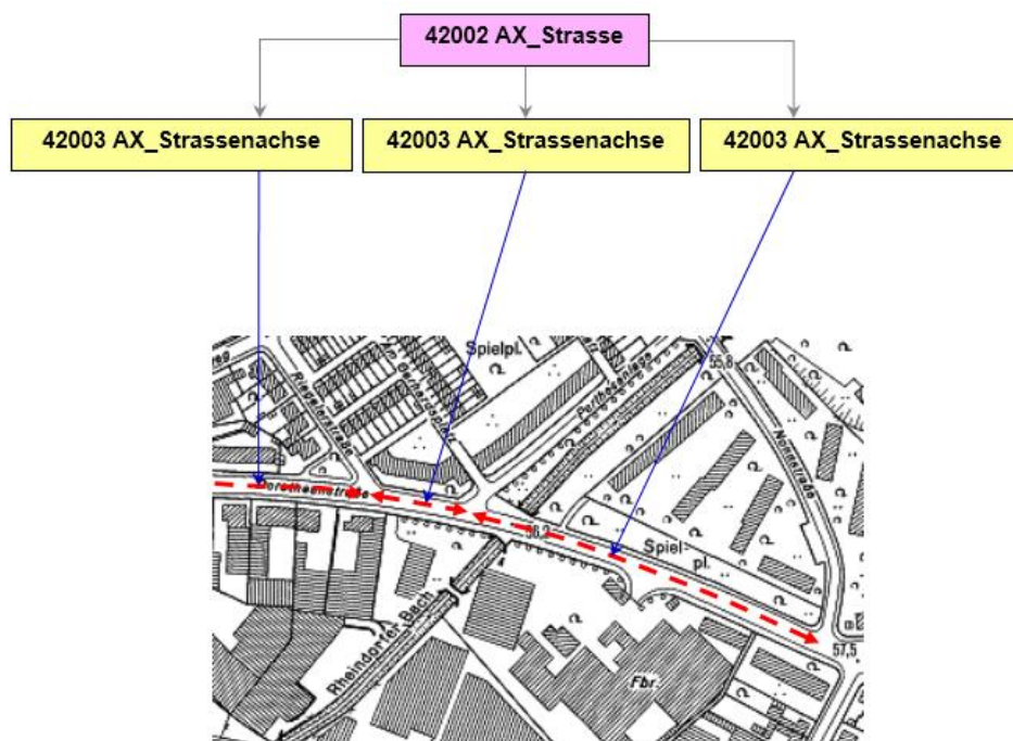
Abbildung 31: ZUSO AX_Strasse besteht aus 3 REO AX_Strassenachse
