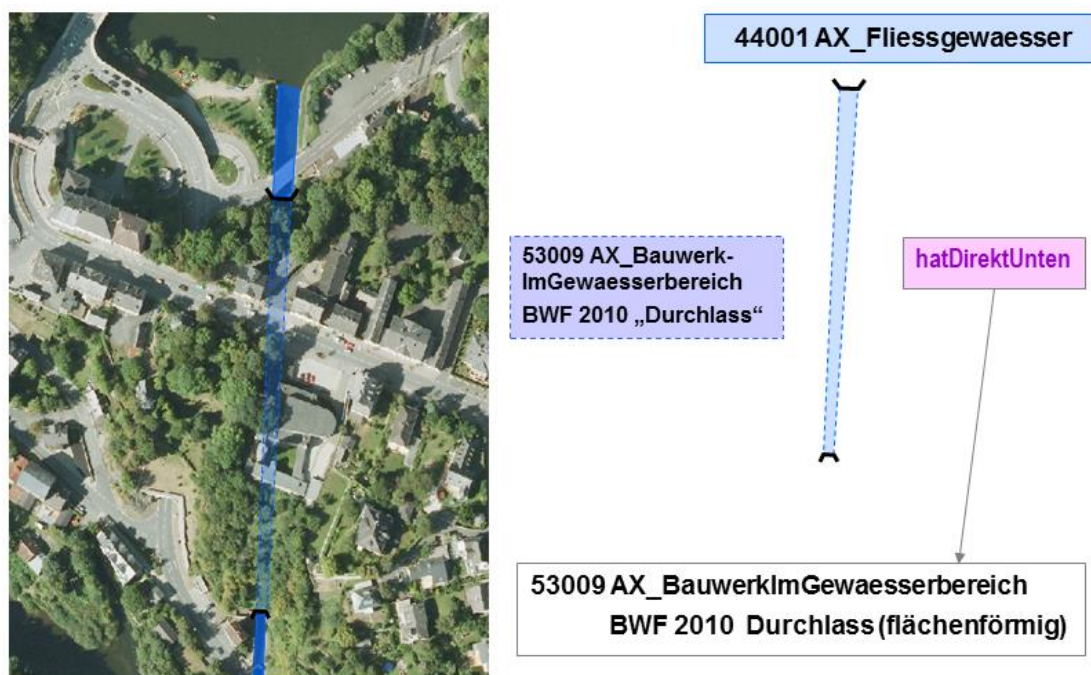
Abbildung 52: Modellierung eines flächenförmigen Durchlasses mit einem flächenförmigen Objekt
