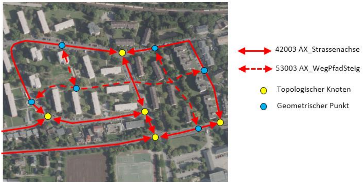
Abbildung 49: Modellierung von Weg, Pfad, Steig mit Straßenachse
