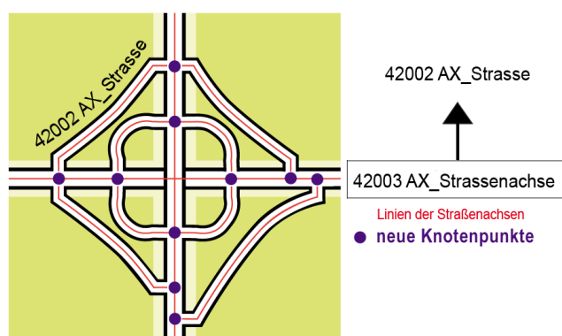
Abbildung 24: Herstellung der Topologie bei der Umwandlung von physisch getrennten zu einfach modellierten Straßen
