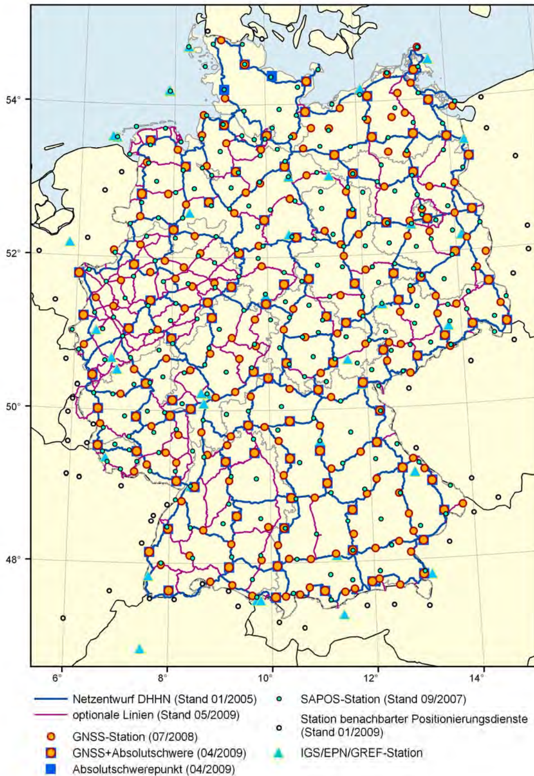
Netzentwurf DHHN mit GNSS-Boden- und Referenzstationspunkten (IGS, EPN, GREF, SAPOS®), Januar 2009
