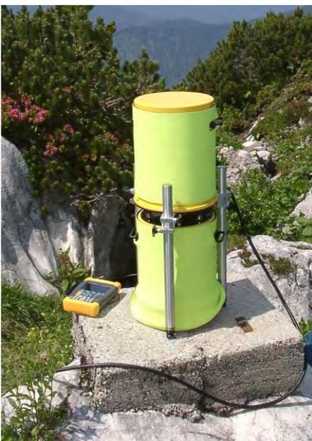
Das Absolutgravimeter A-10 erfordert eine ebene vorzugsweise bodengleiche Aufstellfläche von 50 cm Durchmesser. Die Aufstellung des Gerätes auf unterirdisch vermarkten Punkten ist nicht möglich.
