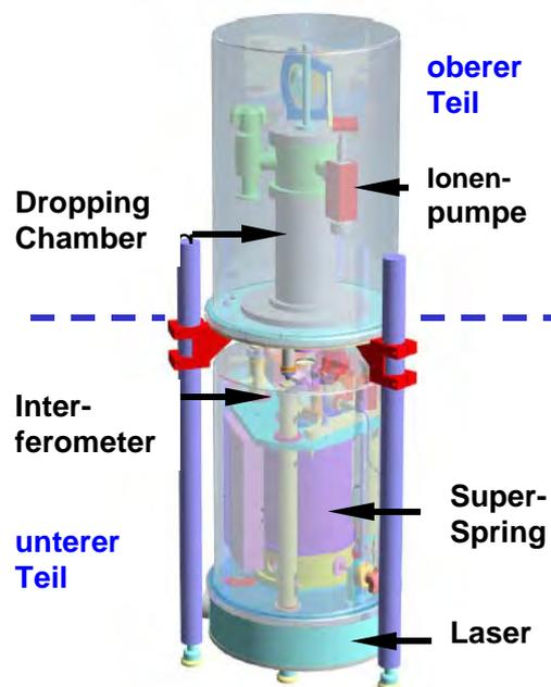
Damit entspricht der prinzipielle Aufbau dem des Gravimeters FG-5, wobei beim A-10 eine kompakte Realisierung des Messsystems in zwei unabhängigen thermostatisierten Gerätebehältern zur Verfügung steht.
