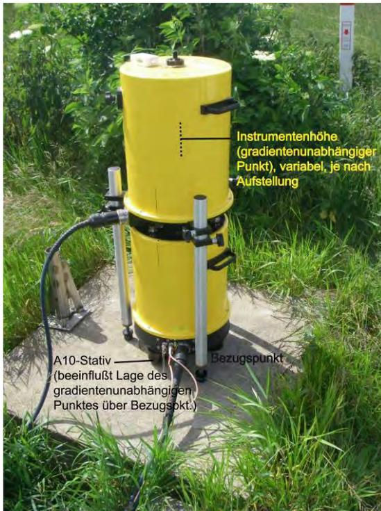
Die Genauigkeit des Absolutschwerewertes im gradientenunabhängigen Punkt beträgt ca.  $0,09 \mu\text{m/s}^2$  und entspricht der Messgenauigkeit des A-10 unter der Voraussetzung der kontinuierlichen Überwachung der Instrumentenstandards, der regelmäßigen Kontrolle der Geräte auf der Referenzstation Bad Homburg sowie von zwei unabhängigen Aufstellungen während der Messung am Punkt.
