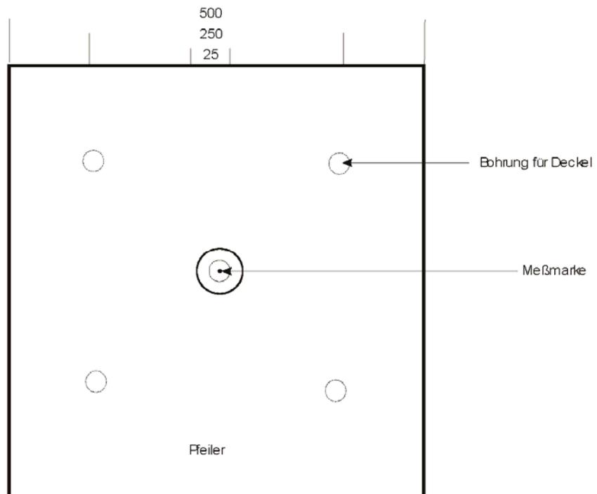
Abb. 2: Draufsicht ohne Deckel (Angaben in Millimeter ohne Maßstab)
