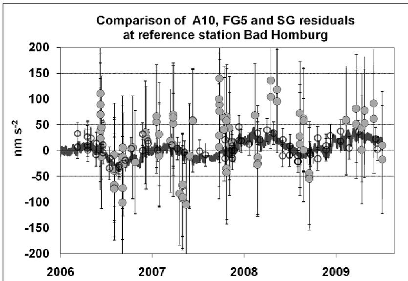
Abbildung oben: Messungen mit dem A-10#012 (graue Kreise) auf der Referenzstation Bad Homburg im Vergleich mit FG-5-Messungen (weiße Kreise) und der Residualzeitreihe (schwarze Linie) des supraleitenden Gravimeters (bezogen auf den mittleren Schwerewert 9.810.550.450 nm/s<sup>2</sup>)
