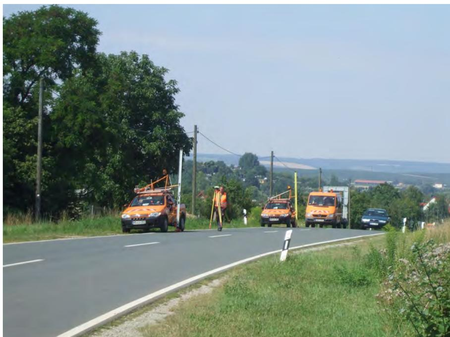
Abbildung 13.20.: Teilmotorisiertes Präzisionsnivellement.
