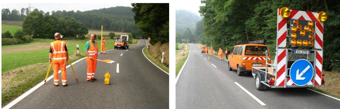
Abbildung 13.10.: Präzisionsnivellement 1. Ordnung im Straßenbereich mit Verkehrssicherung.
