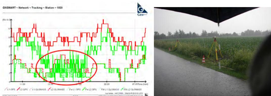
Abbildung 7.12.: Fixing-Verhalten GGP 1920 im „reduzierten GGP-Netz“ in Session 6 (links) bei Starkregen (rechts).
