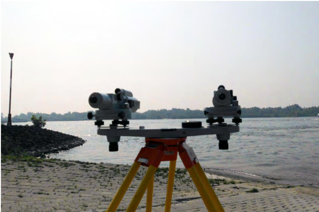
Abbildung 13.16.: Stromübergangsnivellement am Rhein.
