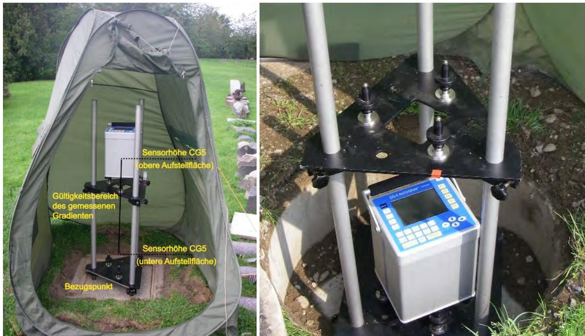
Abbildung 10.2.: Relativgravimeter Scintrex CG5 und zur Gradientenbestimmung genutztes Spezialstativ.
