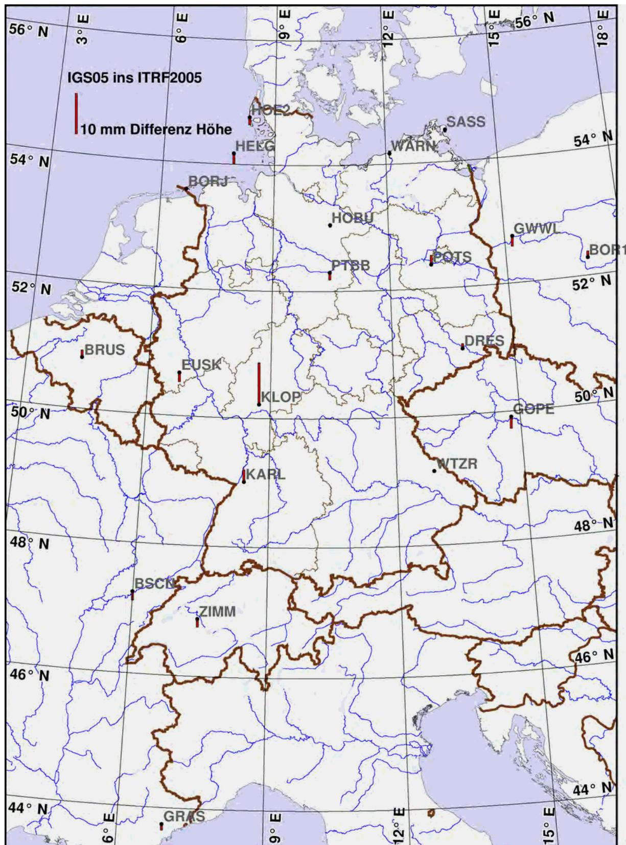
Abbildung 8.38.: Restklaffungen der Höhenkomponente nach der Koordinatenkonvertierung der kombinierten Lösung vom IGS05 ins ITRF2005.
